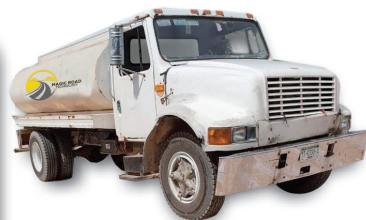
Camion-citerne épandeur de liquide Liquid spreader tank truck
